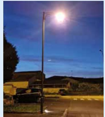
Le changement des ampoules se poursuit sur les lampadaires de l'éclairage public. Rue après rue, en conservant chaque fois que c'est possible les luminaires en place, l'entreprise met une ampoule LED en remplacement de l'ampoule au sodium. L'éclairage ainsi fourni est plus doux, dans la même tonalité orange que le précédent, et plus économe des 2/3 en énergie.
