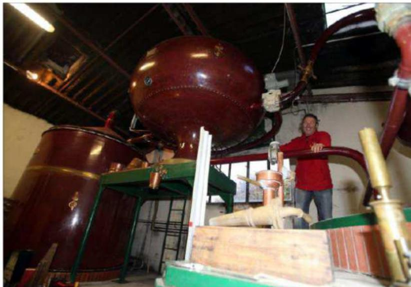
L'alambic des frères Painturaud date du milieu des années 70. Rien à voir avec les modèles d'antan, mais pas encore au niveau des modèles actuels, où l'électronique permet au bouilleur de beaucoup moins surveiller sa distillation. Photos Majid Bouzitt
