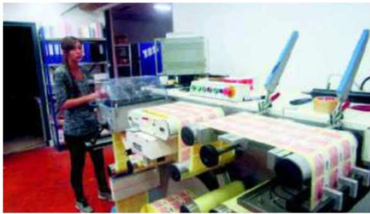
Une machine pour découper les bobines d'étiquettes. D.F.
