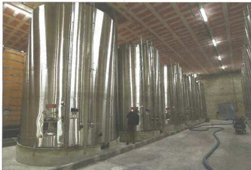
Des cuves en inox permettent de conserver la réserve climatique, stockée obligatoirement en cuve inerte.
