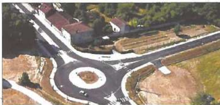
Le giratoire a un rayon extérieur de 16,5 mètres. PHOTO DR
