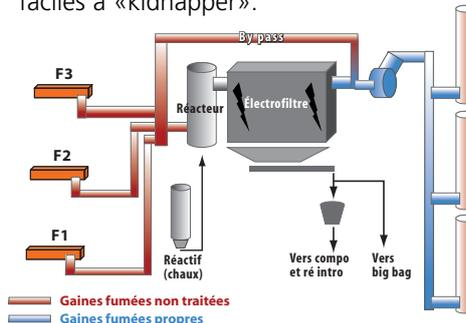
Reste à regrouper ces poussières très volatiles : c'est là qu'intervient le filtre électrostatique. L'action d'un champ électrique de 40 000 volts plaque les particules polluantes aux électrodes tandis que les fumées propres et invisibles s'échappent librement par les cheminées.
